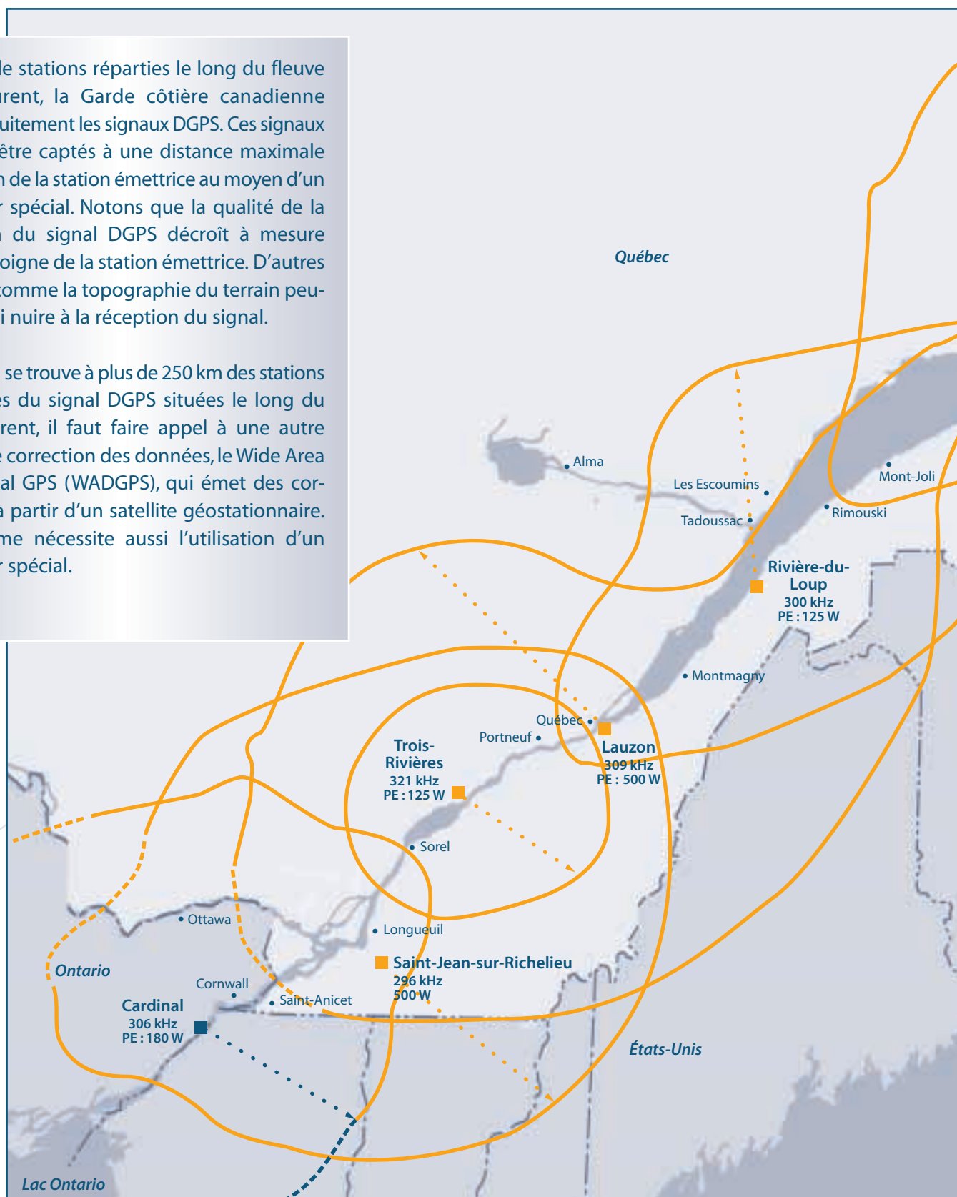
Couverture du réseau DGPS – Région laurentienne (limite de couverture à 75 et à 100 \mu\text{V/m} )
